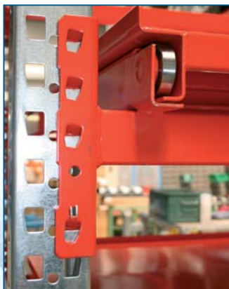
Gesteckte Traversen und Schubfächer mit Kugellagerführung.
