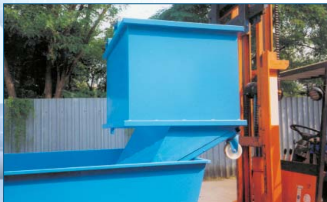
Bodenklappe mit Zentrierwänden – für akkurates Entleeren, ideal für Kleinteile.
